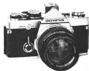
Olympus OM-2 elektronisk Elektronisk OM-system kamera. Lysmåling i selve filmplanet og computerstyring af lukkeren under selve eksponeringen med 1/70.000 sek. målereaktion. Øjeblikkelig korrektion af enhver lysændring, fra 1/1000 til 120 sekunder. TTL-styret blitzautomatik i forbindelse med Olympus T-serie flash, hvor selve OM-2 kameraet afbryder blitzglimtet nøjagtigt når filmen har fået lys nok, over alle objektivbrændvidder. Hele OM-systemet passer også til OM-2. Diodelampe i søgeren for flashberedskab og efterkontrol af flash-eksponering.
